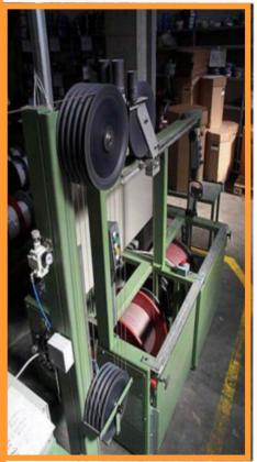
VELOCITA': 300 mt /min. su bobina con tamburo 250 mm. 0
